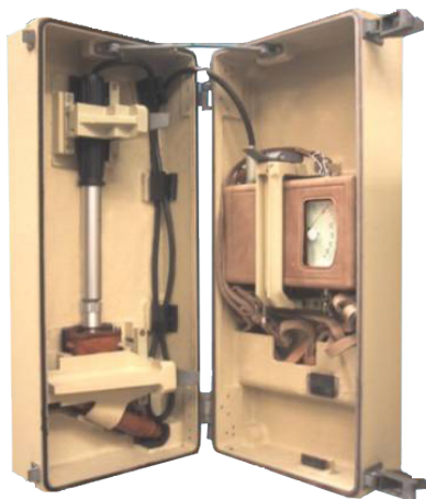
Рис. 61. Щит с КДГ-1
