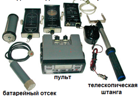
Рис. 36. Общее устройство измерителя мощности дозы ИМД-7Н
