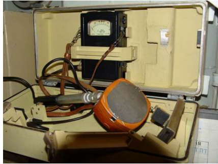
Рис. 41. Радиометр для измерения бета-загрязненности поверхностей КРБ-1
